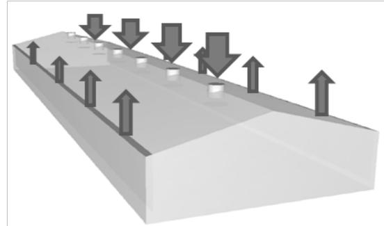
(d) case4 – roof with diffuser in, side up out
